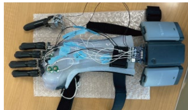
手のひらから先を失った患者の筋電義手の内部構造。左側の指の中にモーターが入っている。右側の箱はバッテリーとコンピューターで、手首に装着する
